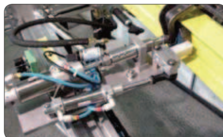
GVP systém pro mazání dopravníkových řetězů
