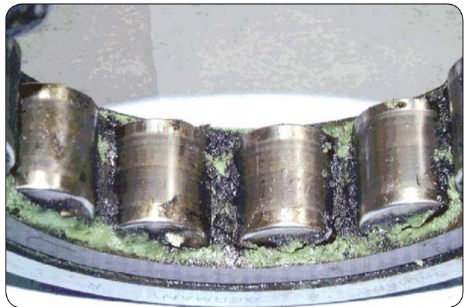
Degradace maziva způsobená elektrickými výbojovými proudy
