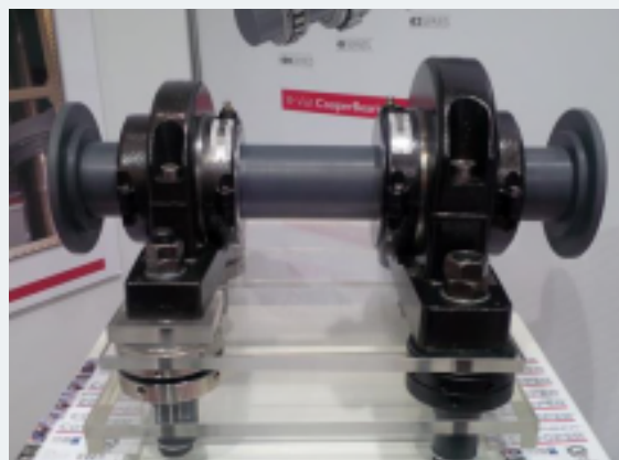
Obr. 6: Příklad komplexního řešení uložení pro loď: sestava hnací hřídele uložená v ložiskové jednotce Cooper s děleným válečkovým ložiskem Cooper 100 a jednotce s děleným dvouřadým kuželíkovým ložiskem s možností nastavení výšky pomocí podložek SKF Vibracon. Toto řešení bylo předvedeno na veletrhu námořní dopravy SMM v roce 2014 v německém Hamburku.
