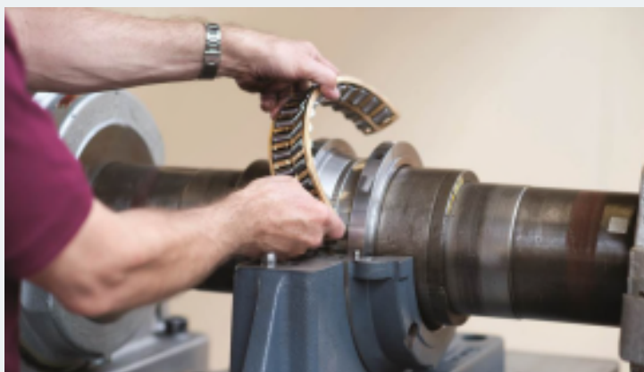
Obr. 5: Jedinečná konstrukce společnosti Cooper – dělené dvouřadé kuželíkové ložisko.
